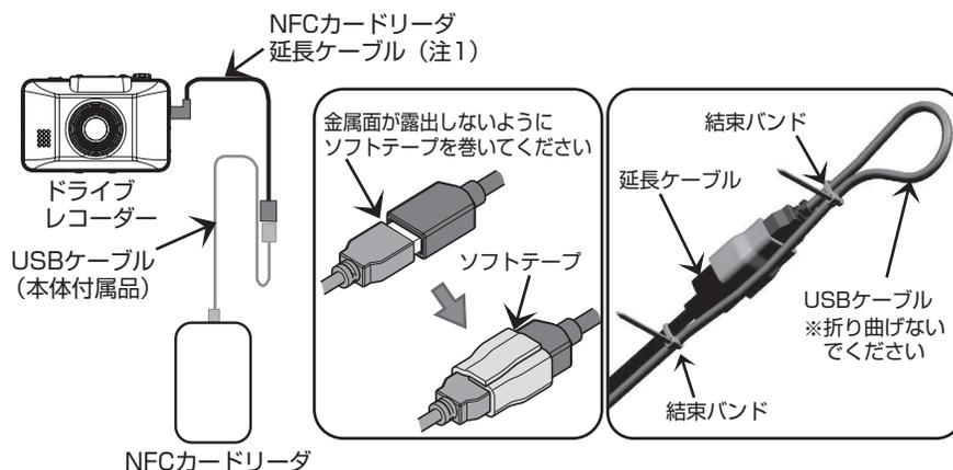
延長ケーブルをドライブレコーダーの電源ケーブルに結束バンドを使用して結束する際は、下図のように延長ケーブルが突っ張らないようにたるませて結束してください。
